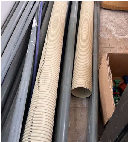
53 ALCANTARILLADO D=160 MM * 1M
